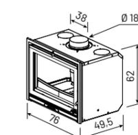
En version standard les inserts **MODANE**, fonte et vitrée, sont disponibles avec une évacuation des fumées en Ø 180 mm. Pour une simplicité d'installation dans le cadre de la rénovation, les inserts **MODANE 65** sont également proposés en Ø 150 mm. Les performances de l'appareil restent inchangées.
